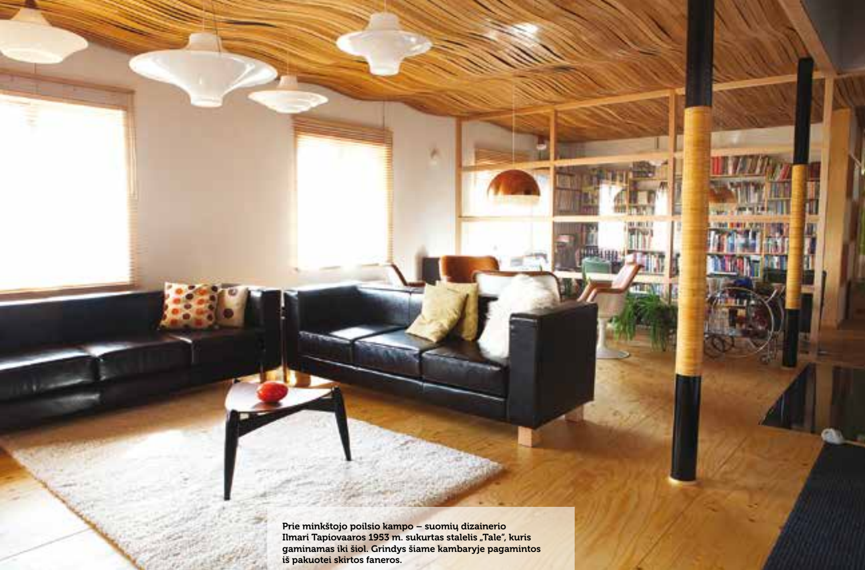
Vaizdas į virtuvę ir koridorių. Lubos pagamintos iš parketo gamyklos medienos atliekų. Tokios lubos sukuria gerą akustiką ir yra lengvai prižiūrimos – po kelerių metų nešvarumus nuo jų galima susiurbti dulkių siurbliu.
